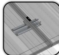
Puis serrer les deux **F.U.** concernées par le module (*opération à répéter jusqu'au dernier module de la rangée*).
