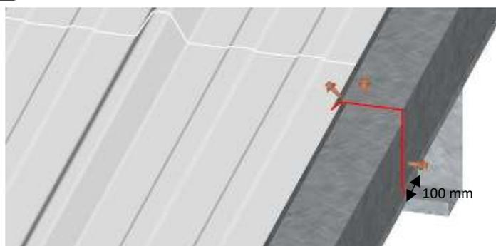
La pièce de rive inférieure doit toujours se trouver sous la pièce de rive supérieure avec un recouvrement de 100 mm.
