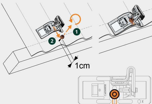
1. Desserrez la vis de la plaque de toit de 1 cm, ne la retirez pas de la panne.
