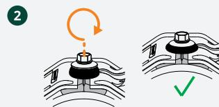
2. Serrez la vis jusqu'à ce que le joint EPDM du support entre en contact avec le joint en caoutchouc de la vis.
