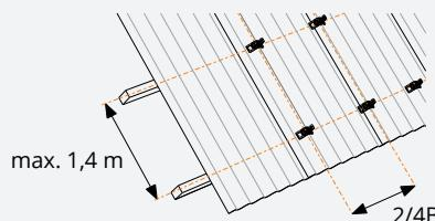
N'utilisez les vis des tôles de toiture (existantes) que dans les positions prescrites par le fournisseur de tôle ondulée. Aucune vis ne peut être ajoutée dans d'autres positions. Montage exclusif sur le sommet de l'onde et juste au-dessus de la panne.
