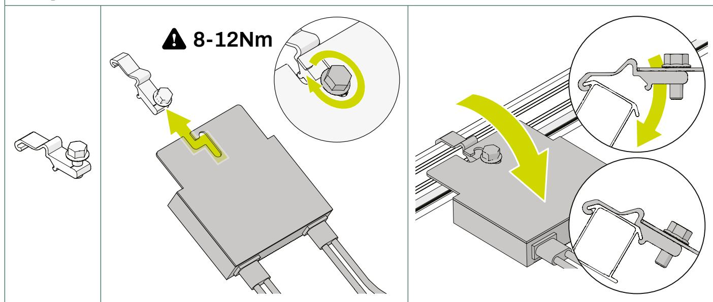
**6. Montage des panneaux solaires avec des pinces de panneau de 60 mm.****MONTAGE DU PREMIER PANNEAU**
