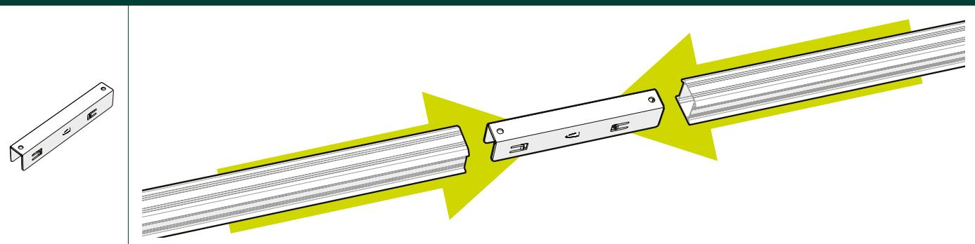
**5** Si le porte-à-faux est supérieur à 250 mm : étendre le rail de montage jusqu'au chevron ou liteau suivant.
