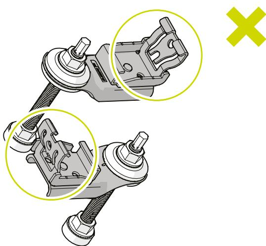
**9** Serrez l'écrou en haut de la Vis à double filetage
