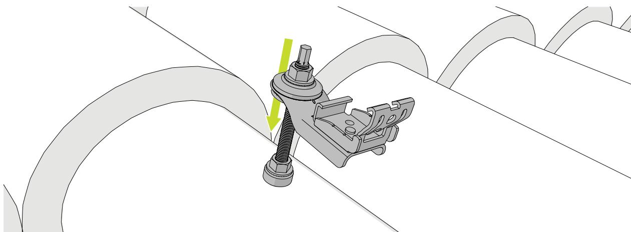
**6** Serrez l'écrou de sorte que le joint en caoutchouc se déforme et que les orifices de fixation soient comblés.
