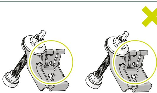
**i** Pour une orientation avec rails verticaux, assurez-vous que les adaptateurs sont tous placés du même côté de la vis à double filetage avec les clickers pointant dans la même direction.
