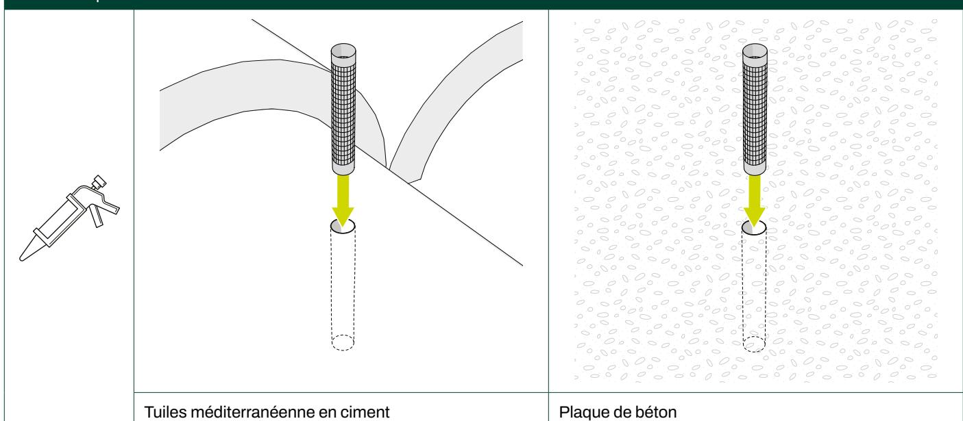
**5** Insérez la Vis à double filetage et laissez l'ancrage chimique durcir.
