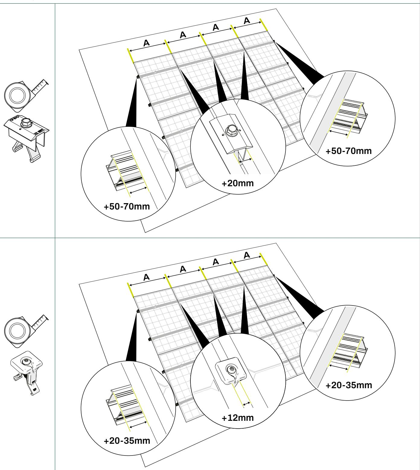
**4** Utilisez des coupleurs pour connecter les rails de montage, si nécessaire
