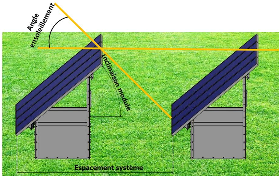
*Schéma disposition GROUND SYSTEM*
