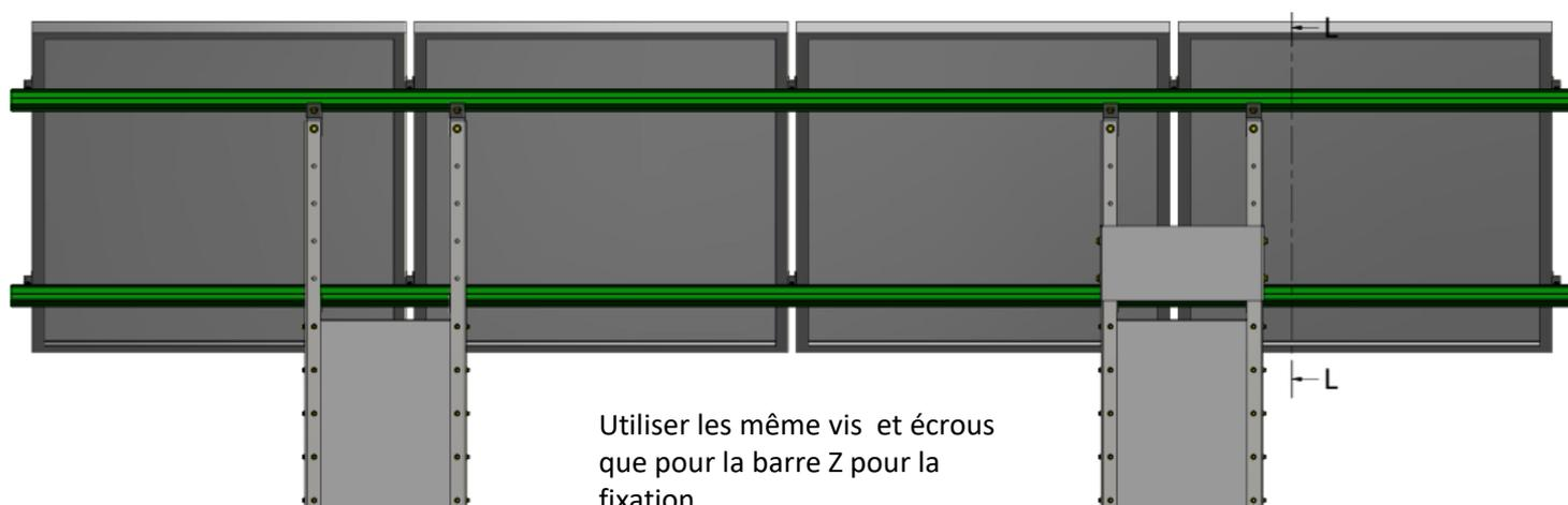
Utiliser les même vis et écrous que pour la barre Z pour la fixation.
