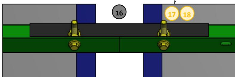
Assembler la barre à l'aide de l'éclisse fournie (réf. 16, 17, 18). Ajuster la taille de l'installation si besoin à la taille des modules en prenant soin de laisser un écart de 5mm entre les modules pour favoriser le passage du vent.
