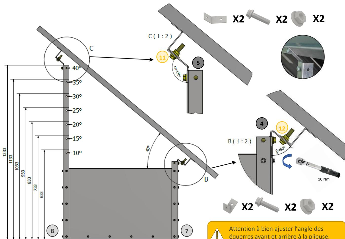
⚠ Attention à bien ajuster l'angle des équerres avant et arrière à la plieuse.
