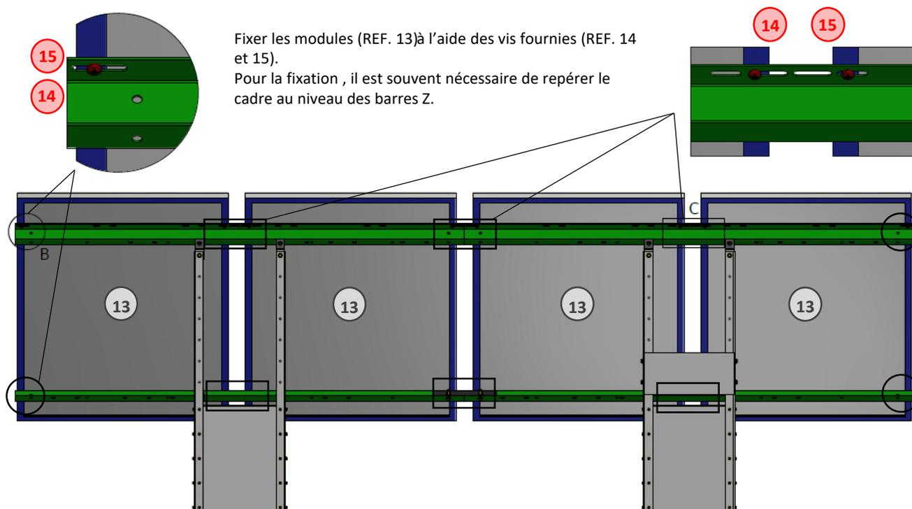
**! Astuce :** Positionner un liteau à l'intérieur du cadre du module lors du perçage pour protéger le verre
