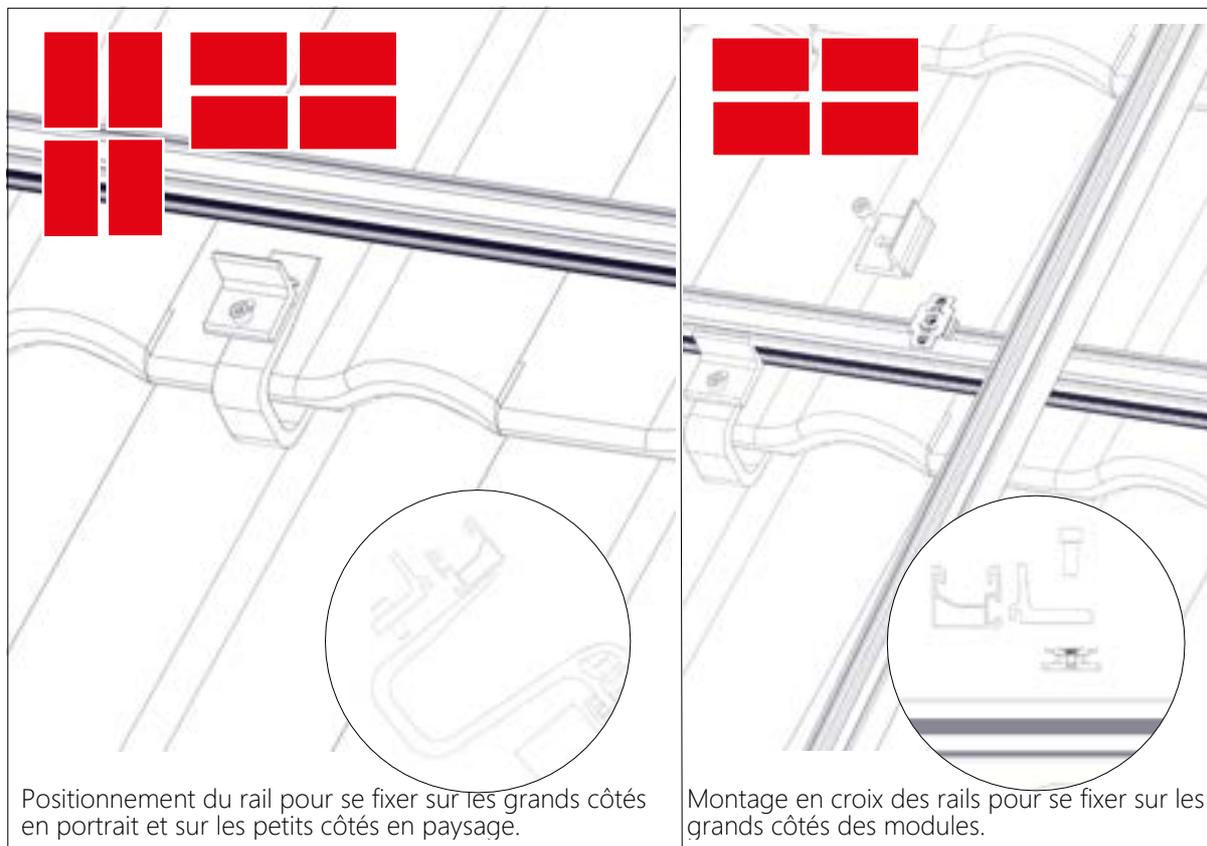
**B: Pose de rail de montage vertical avec adaptateur SR fixé sur le CrossHook 3S/4S et avec vis à tête marteau pour fixer le SolidRail directement sur le CrossHook 3S+/4S+**
