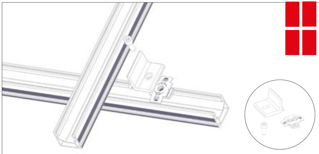
4 Montage des connecteurs de rails (couple de serrage 35Nm)
