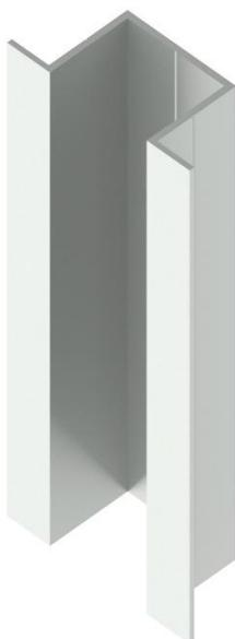
Le profil OMEGA est vissé sur les séparateurs DOUBLE T, il devra être mis parfaitement d'aplomb grâce aux réglages que permet le système. Le premier et le dernier ancrage sur le profil seront installés au maximum à 250 mm des extrémités de ce profil.
