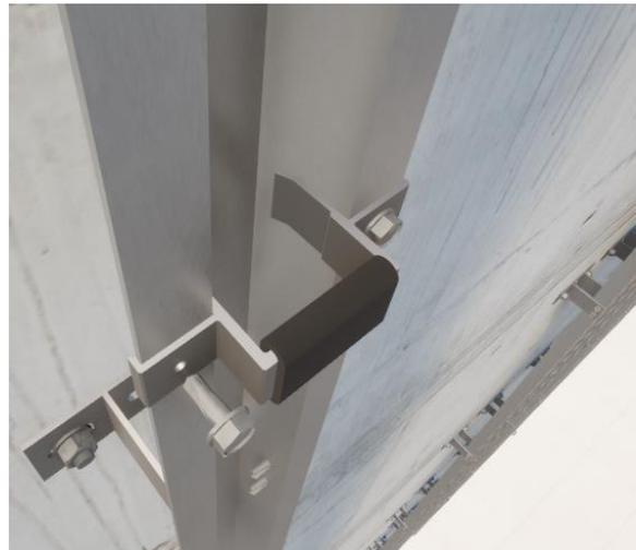
Les ensembles de supports suspensions sont clipsés sur les profilés omégas selon le calepinage de la façade. Même une fois clipsé à l'intérieur de l'oméga ils peuvent être réglés en hauteur en fonction de l'emplacement des encoches de chaque cassette. Une fois les côtes vérifiées chaque coulisseau sera fixé au moyen de deux vis autoperceuses  $\varnothing 4,2 \times 19$  mm inox sfs une sur chaque aile de l'oméga.
