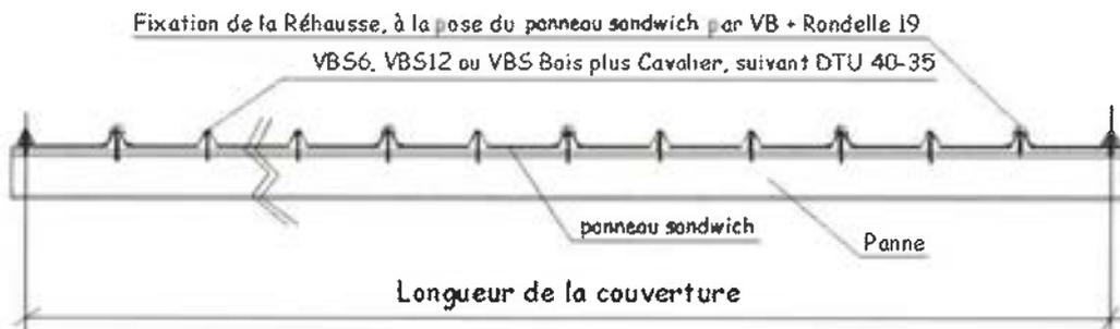
Ainsi, il convient de mettre en place en premier lieu les rehausse inférieures, puis de compléter la fixation de la couverture à l'aide des cavaliers traditionnels et vis de couture (non fournis) selon les règles des DTU / DTA concernés. Les fixations sont placées en sommet de nervure. Les vis utilisées sont appelées "VBS" ("VBS-6 ou 12" ou VBS-Bois selon l'épaisseur et la nature de la panne).
