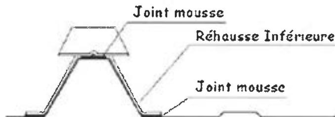
Dans le cas d'un bac sandwich, un perçage doit être réalisé à l'emplacement des vis VBS sur toute l'épaisseur du panneau sandwich jusqu'à la panne (une perceuse à butée de profondeur doit être utilisée en la calant à 1 mm de moins que l'épaisseur totale). L'isolant doit ensuite être débourré pour permettre la mise en place des entretoises, puis des VBS. De plus, une vis de couture VC est utilisée pour maintenir le parement supérieur du panneau sandwich avec la réhausse inférieure.
