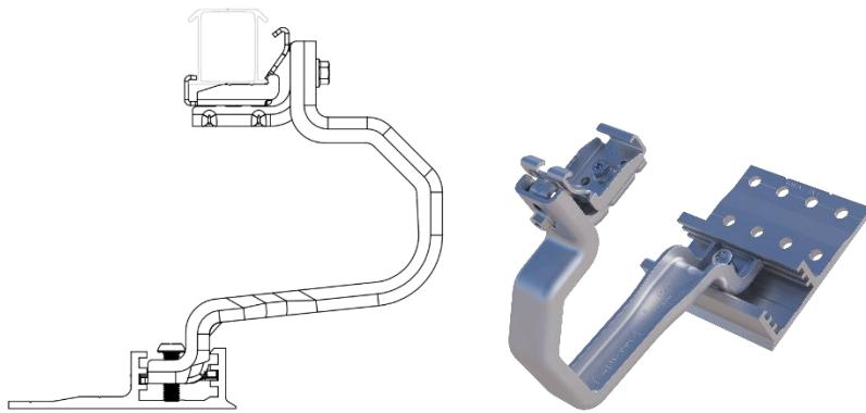
Le crochet Roof Hook pro est composé d'une plaque de base en aluminium et d'un crochet en Magnelis équipé du Clicker Esdec fixe, conçu pour la pose **uniquement horizontale** des profilés.
