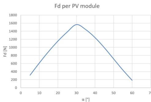
La pente vers le bas du graphique aux inclinaisons de toit supérieures à 30 ° est due à la valeur changeante de  $\mu_1$ , qui est définie comme  $0,8 \cdot (60-\alpha) / 30$  pour les inclinaisons de toit  $30^\circ < \alpha < 60^\circ$ . Avec une accumulation de neige de 2 m au niveau des panneaux supérieurs, la force parallèle est calculée comme suit :
