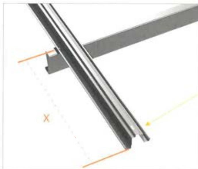
Placer le second rail à un entraxe E ( $\pm 1\text{mm}$ ) tel que défini ci-après et indiqué sur les plans de calepinage final.
