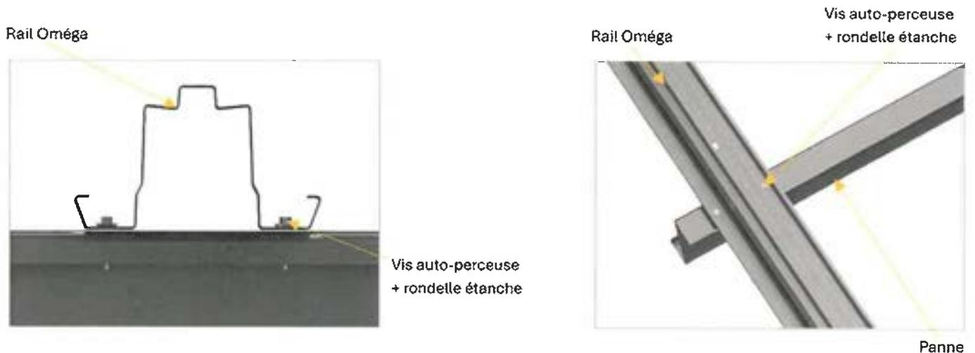
Les vis de fixation utilisées dépendent de la nature de la charpente. Il y a lieu de se référer à l'art 4.3 du présent rapport.
