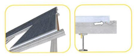
Etape 3: Poser le panneau suivant et clipser la traverse, soit en exerçant une pression sur la traverse (image 3.1 de la notice), soit en faisant pivoter le module (image 3.2 de la notice), puis pousser la colonne vers le bas.
