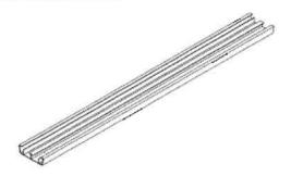
La traverse H140 en aluminium EN AW6060 T66 brut n'a aucun rôle mécanique. Elle a pour seul but le drainage des eaux de pluie vers les rails qui eux même se déversent dans les chéneaux.
