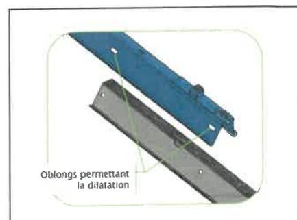
*Ce mode d'éclissage permet de maintenir l'alignement d'un profil par rapport à l'autre et de permettre la libre dilatation des profils*
