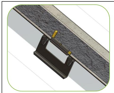
Cette clé en acier inox 1.4301 permet de bloquer au soulèvement le rail dans le support tout en lui laissant la liberté de se dilater par rapport aux supports.
