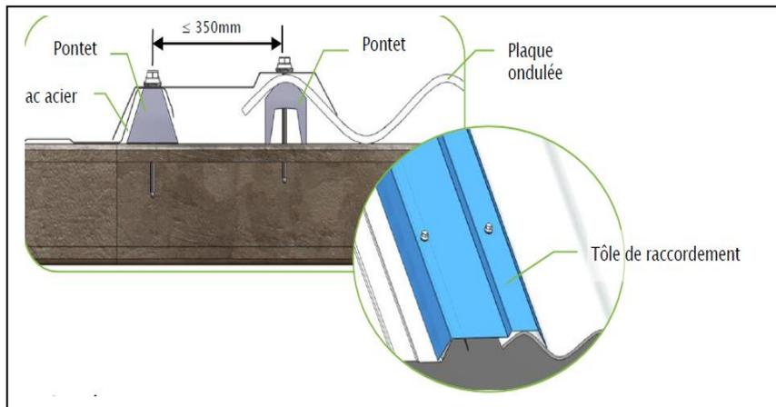
Poser des pontets sous les deux ondes du raccordement.
