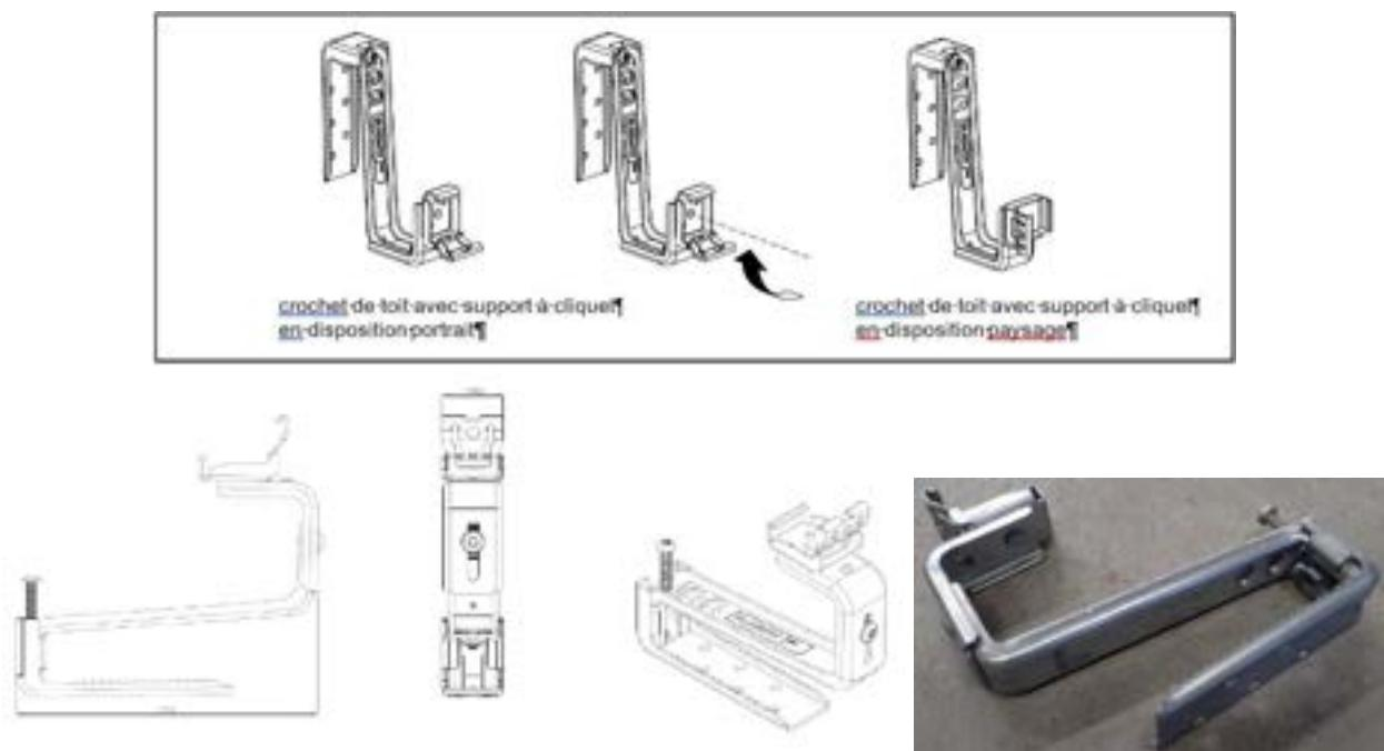
Contrairement aux crochets « Truss Hook », les crochets « Universal Hook » sont insérés sur la sous-structure bois sans aucune vis dans le bois : la liaison s'effectue par frottement (ou par pincement).
