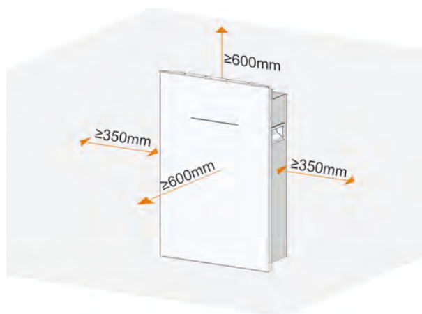
Figure 4-1 Espace autour de la batterie
