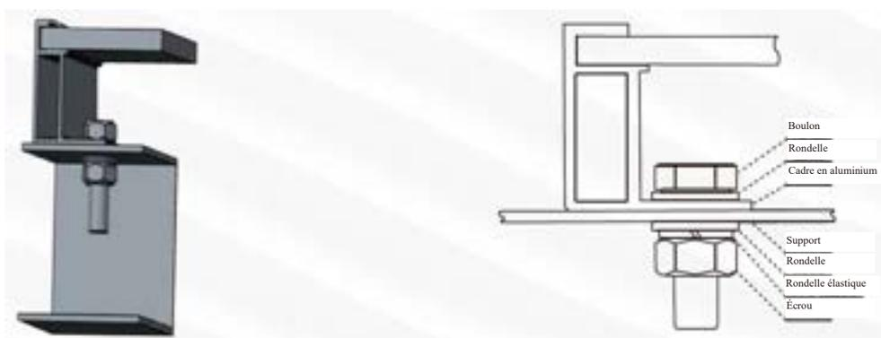
Figure 5 Installation de boulons des modules monofaciaux
