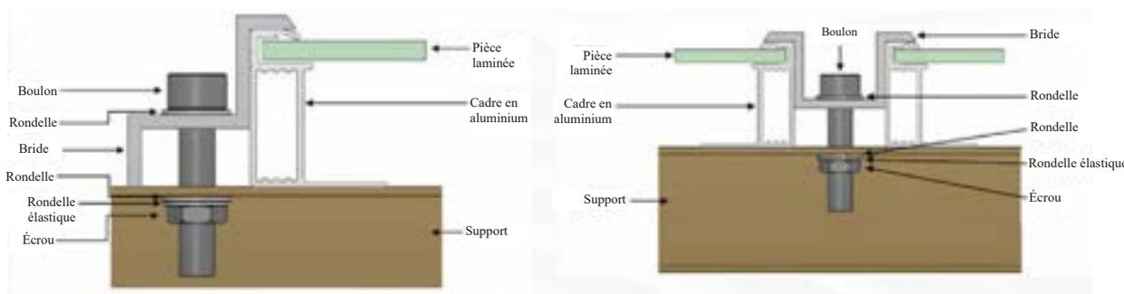
Figure 6 Installation par brides des modules monofaciaux
