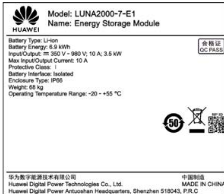
Figure 2-12 Plaque signalétique d'un module de stockage d'énergie
