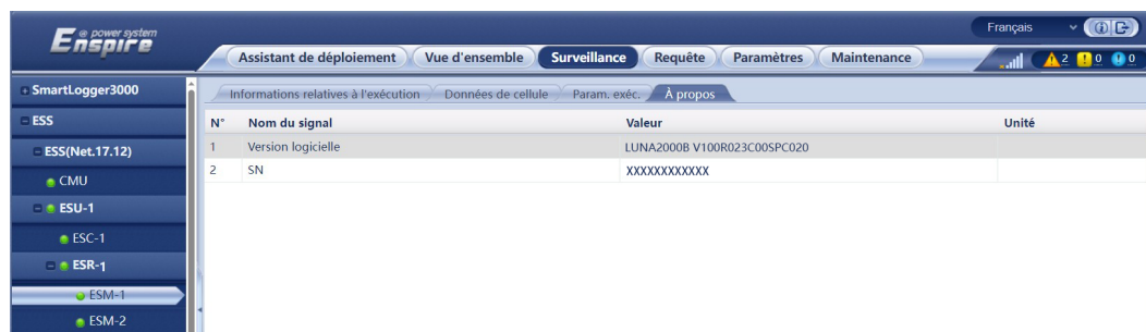
Figure 10-5 Vérification de la version logicielle ESM
