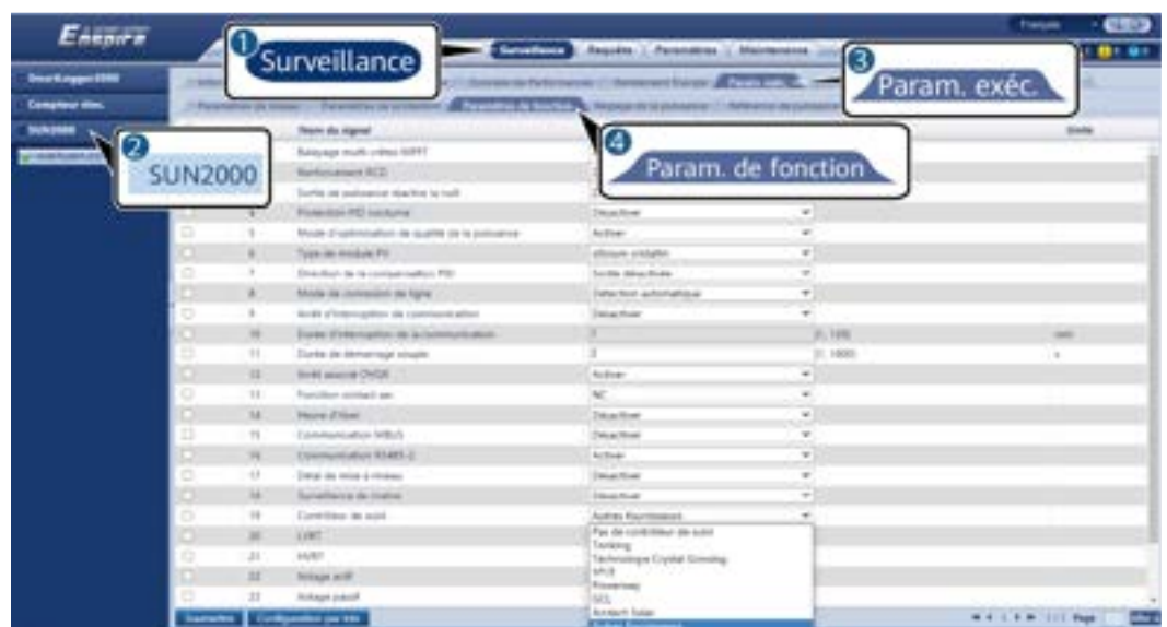
Figure 6-46 Configuration du contrôleur du système de suivi
