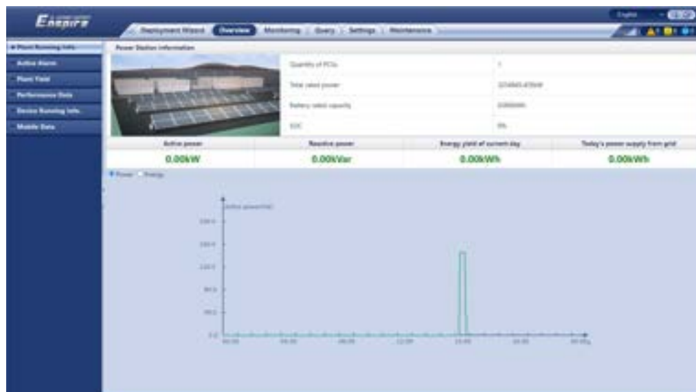
Figure 6-4 Informations relatives à l'exécution de la centrale (avec batterie mais sans compteur électrique)
