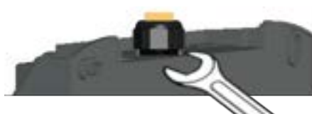
Fig. 6-15: Serrage du passe-câble à l'arrière
