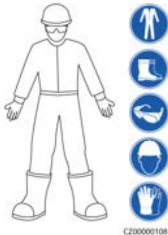
Figure 1-1 Équipement de protection individuelle
