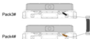
**Illustration 6-3** Insérez les fiches fusibles dans les bases des PACK
