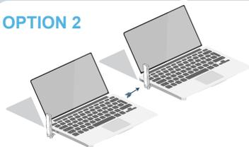
**Remarque :** Veuillez ne pas installer le SLA directement au-dessus du métal ou du béton pour éviter la dilution du signal.
