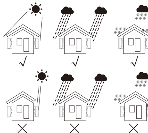
Figure 5.1 Lieux d'installation recommandés
