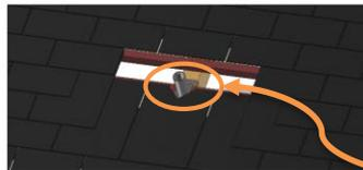
IL POURRA ÊTRE NÉCESSAIRE DE DÉCOUPER L'ARDOISE JUSTE EN DESSOUS DU PLOT SUPPORT
