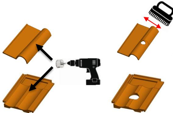
**NB :** IL EST POSSIBLE D'UTILISER PAR EXEMPLE UN « CALQUE » EN CARTON DE LA TAILLE DE LA TUILE POUR REPÉRER L'ENDROIT EXACT OÙ PERCER LA TUILE.
