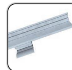
≤ à 40 cm et ne doit pas dépasser de la plaque fibre-ciment au faitage
