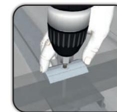
Serrer la vis de la Fixation Universelle Ø 6 mm, vis inox six pans creux.
