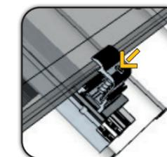
**C** Serrer la vis de la Fixation Extérieure, vis inox six pans creux Ø 6 mm.
