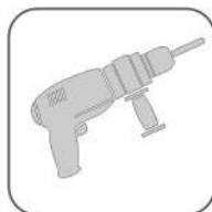
Marteau perforateur ( \varnothing 10 )
