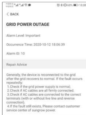
figure 7-9 Informations détaillées sur l'alarme de défaut
