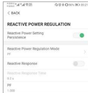
figure 7-17 Régulation de la puissance réactive
