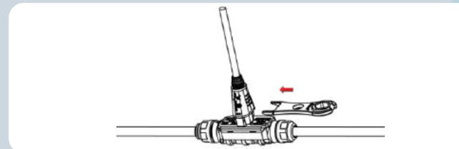
F. Connectez le câble DC du module au câble DC du micro-onduleur.
