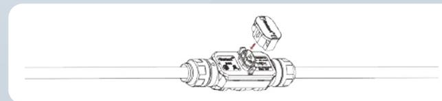
**Remarque :** Dans les cas où il est nécessaire de retirer le câble AC de l'onduleur du port de bus, veuillez utiliser l'outil de déverrouillage du connecteur AC et insérer l'outil sur le côté du port AC.
