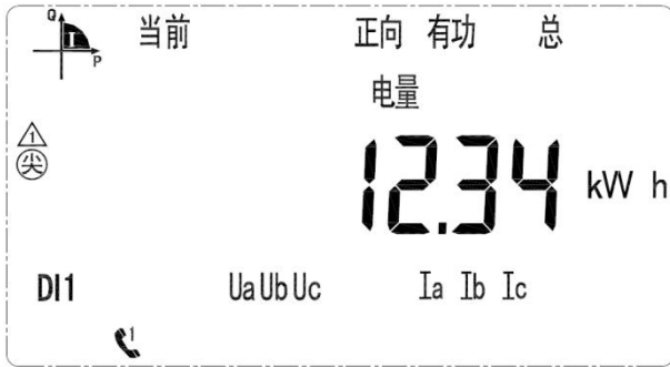
当前正向有功总电量 12.34kWh
