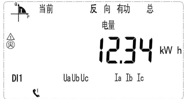
当前反向有功总电量 12.34kWh
